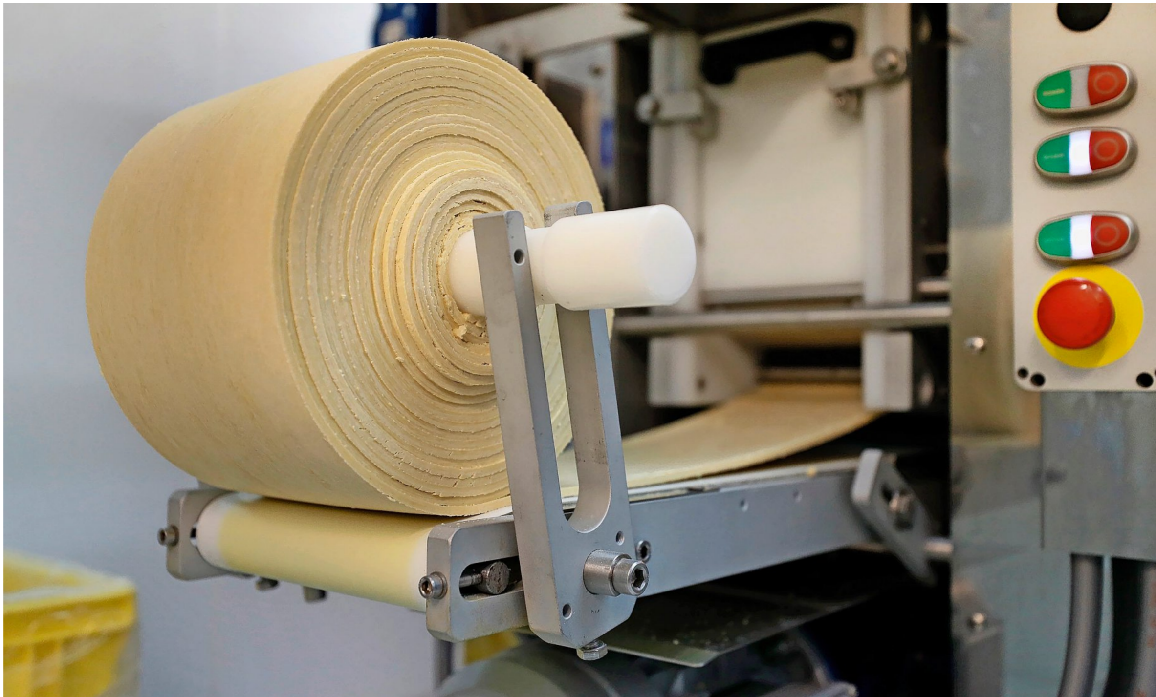
Nachdem der Teig eine halbe Stunde lang gerührt worden ist, wird er aufgerollt und darauf in eine weitere Maschine eingespannt. Diese schneidet dann die Nudeln in der gewünschten Breite zu.
